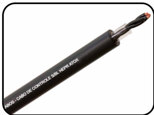
**Características:** Formado por fios de cobre eletrolítico nu, têmpera mole, com encordoamento classe 5 (NBR NM 280), isolados em composto extrudado termofixo de borracha etileno-propileno (HEPR/XLPE) 90°C, resistente a chama, torcidos paralelamente e enfaixados com fita separadora de poliéster aplicada helicoidalmente e cobertura em composto termoplástico poliolefínico antichama LSHF/A, LSZH ou HFFR 90°C (ATOX) não propagante a chama na cor preta.
